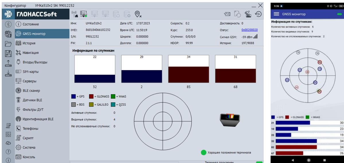
Рисунок 3.16 Вкладка «GNSS-монитор»
