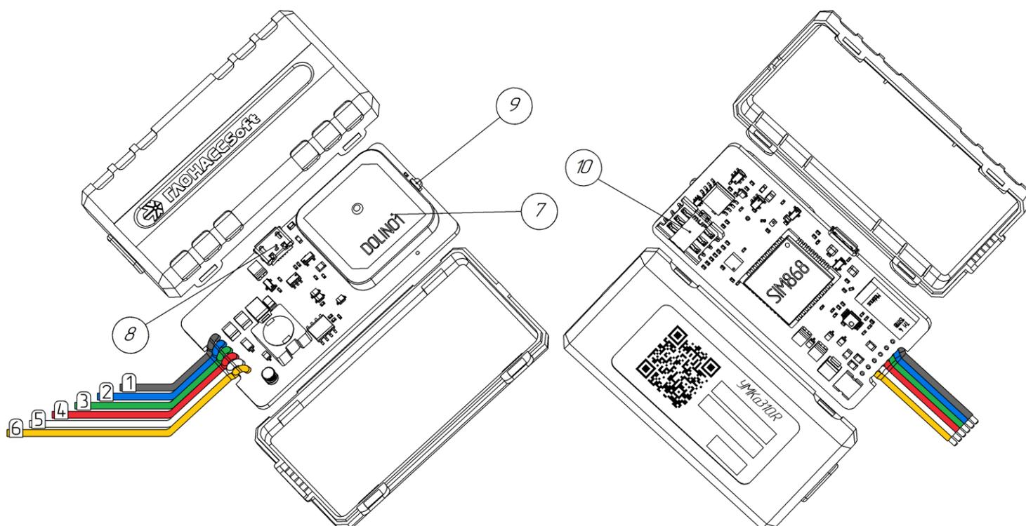
Рисунок 2.1 Основные элементы терминала УМКа310х
