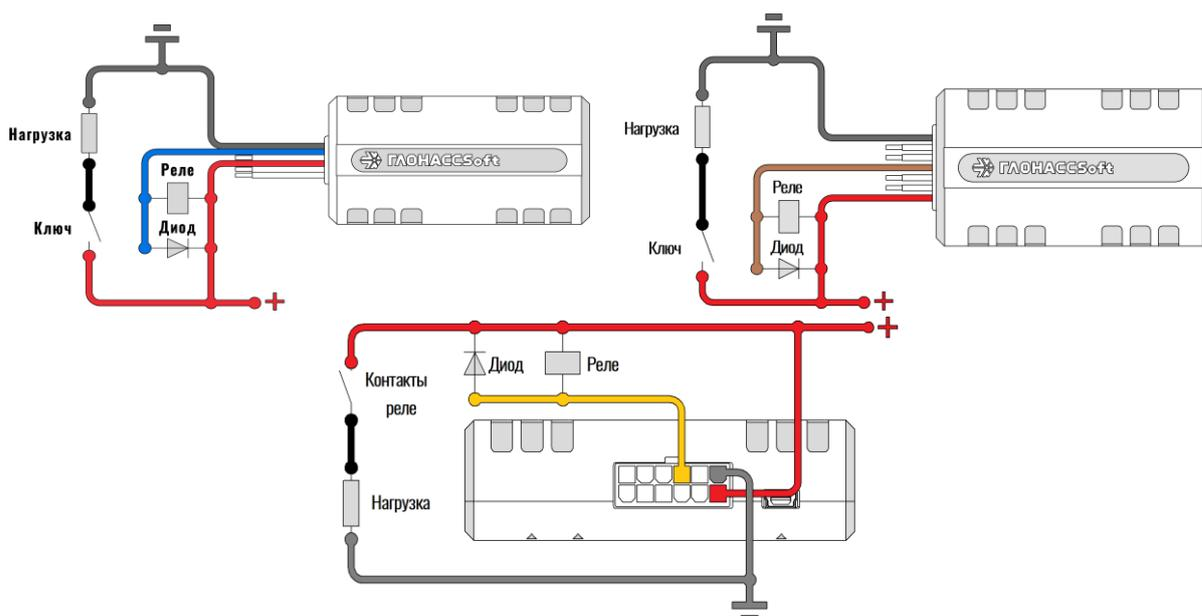
Рисунок 2.20 Подключение мощной нагрузки
