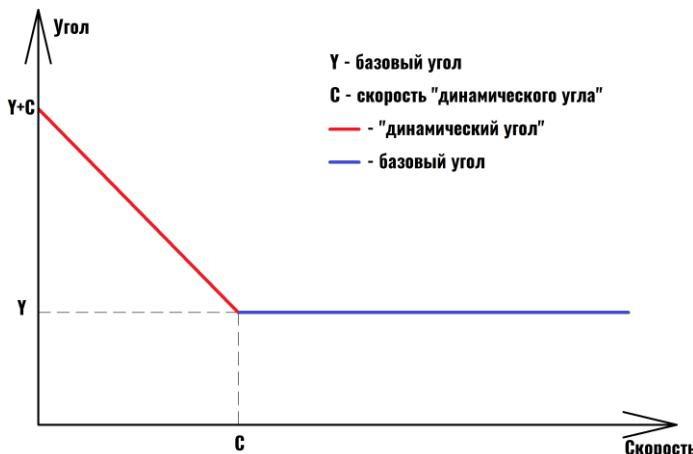
Рисунок 3.19 График зависимости динамического угла от скорости
