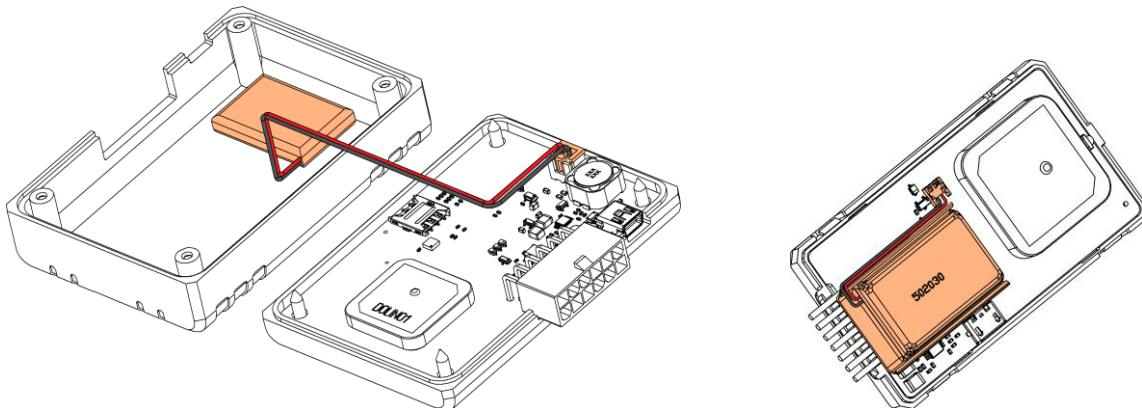
Рисунок 2.11 Установка аккумулятора (УМКа312 –слева; УМКа315 - справа)
