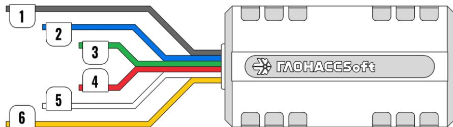
Рисунок 2.5 Нумерация выводов УМКа310x
