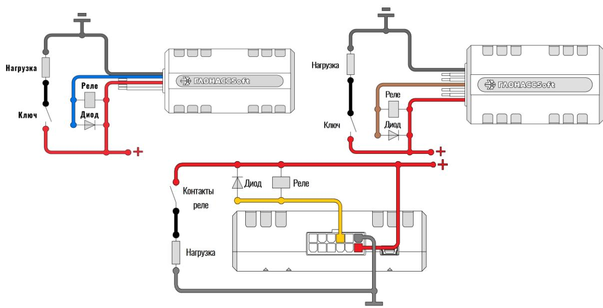
Рисунок 2.20 Подключение мощной нагрузки
