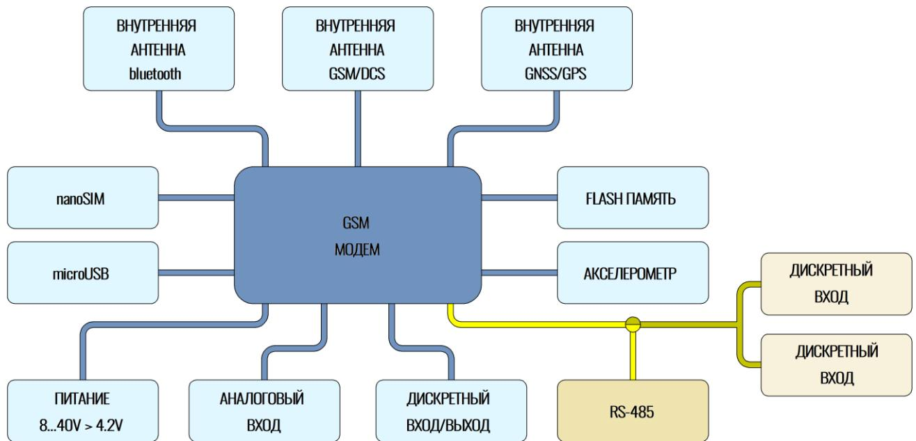
Рисунок 1.2 Блок-схема навигационного терминала УМКа310x
