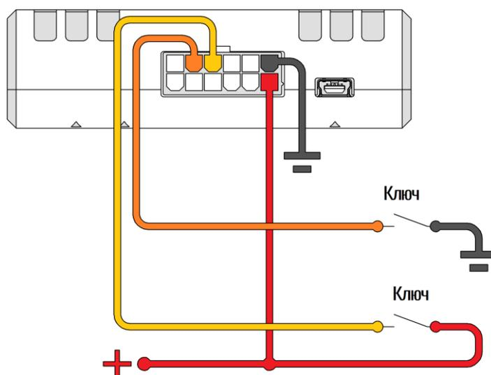
Рисунок 2.18 Варианты подключения дискретных датчиков к УМКа312v2
