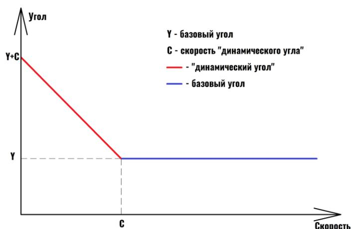
Рисунок 3.19 График зависимости динамического угла от скорости
