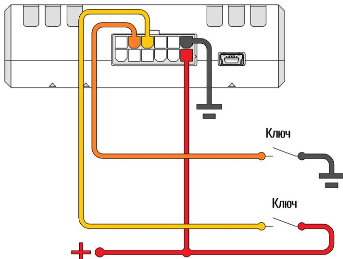
Рисунок 2.18 Варианты подключения дискретных датчиков к УМКа312v2
