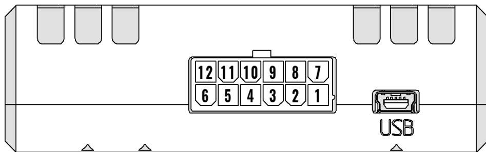
Рисунок 2.7 Нумерация выводов УМКа312x
