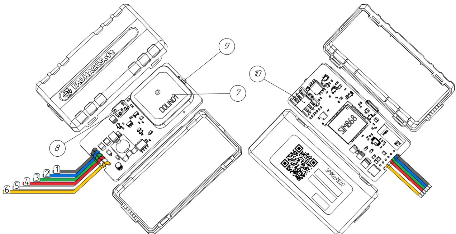
Рисунок 2.1 Основные элементы терминала УМКа310x
