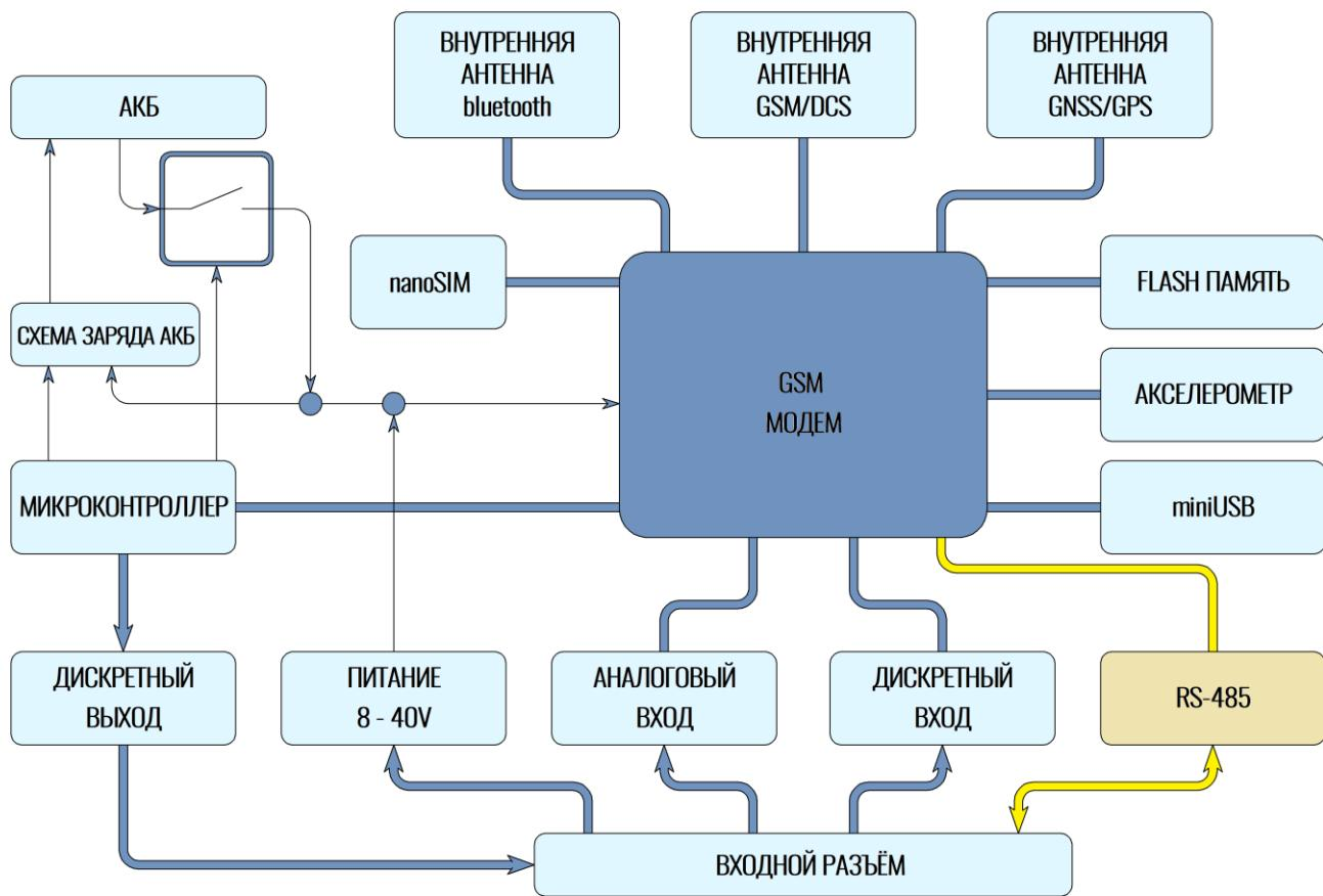
Рисунок 1.4 Блок-схема навигационного терминала УМКа312x
