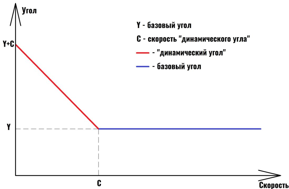
Рисунок 3.18 График зависимости динамического угла от скорости
