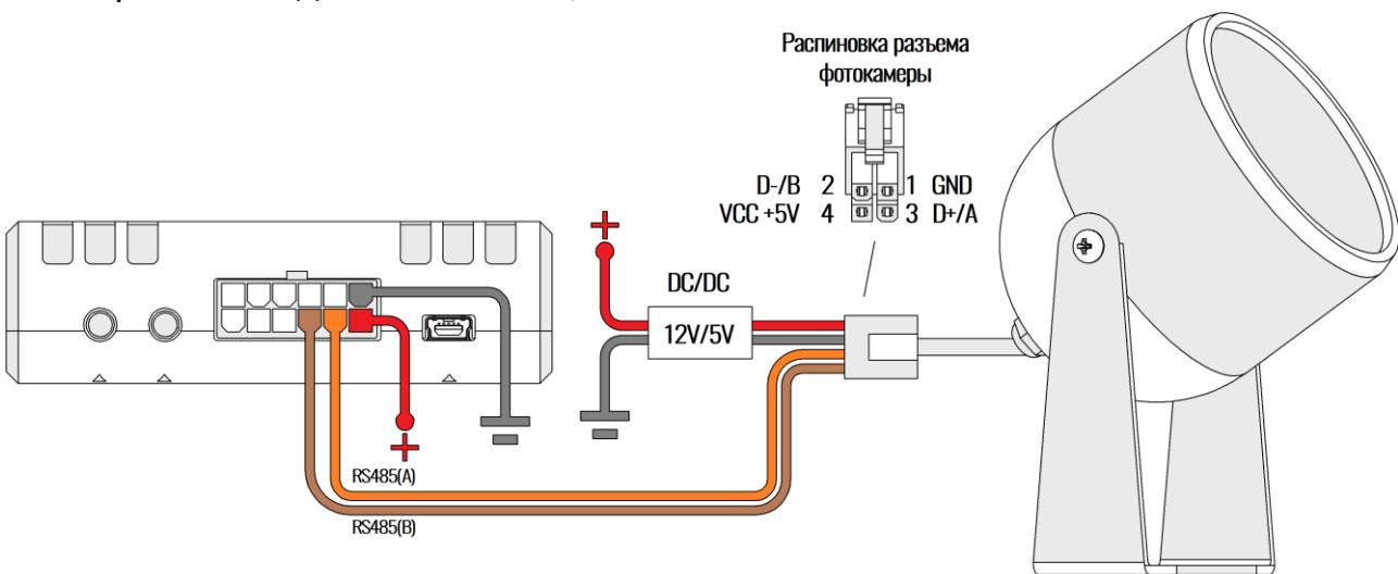
Рисунок 2.31 Подключение фотокамеры JC426F-Q01 с RS-485
