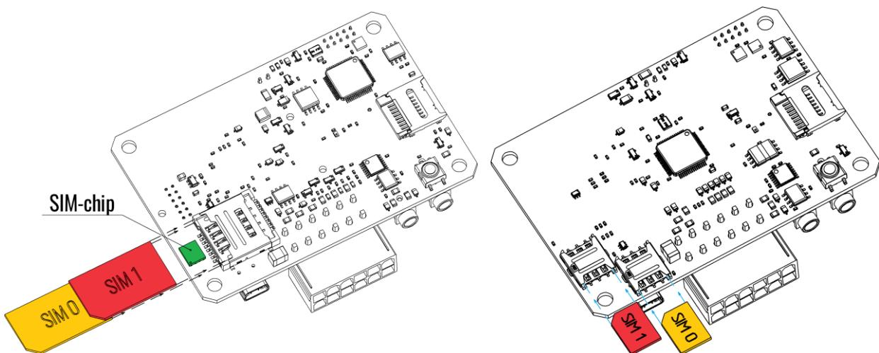
Рисунок 2.8 Установка SIM-карт (справа для УМКа302v2 и УМКа302v3)
