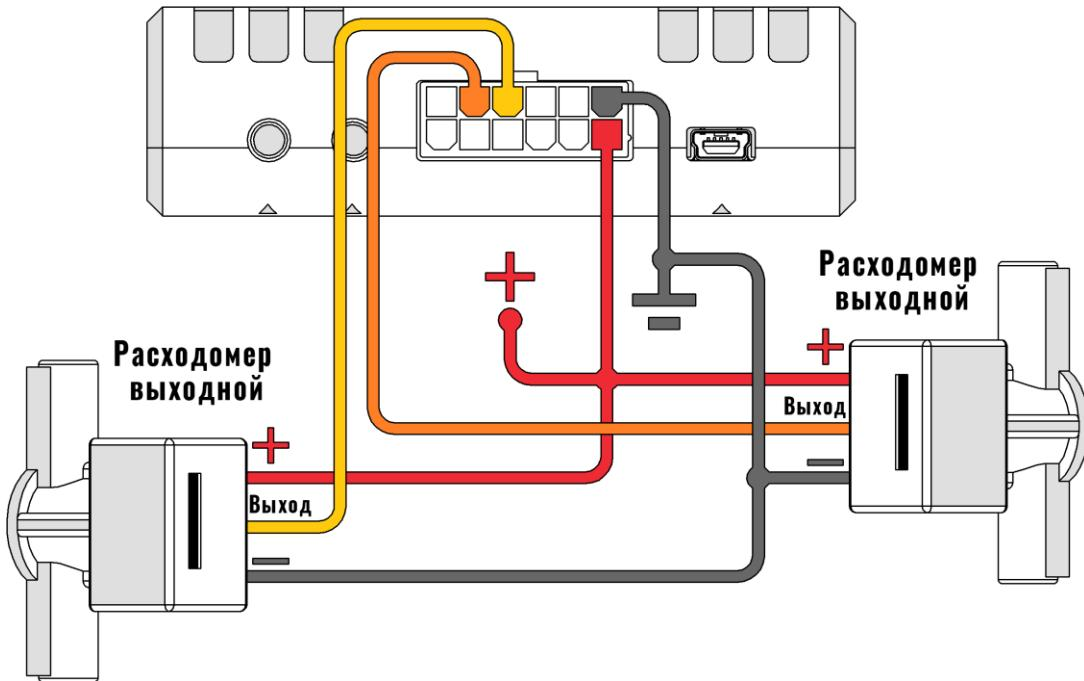
Рисунок 2.17 Пример подключения расходометров в дифференциальном режиме
