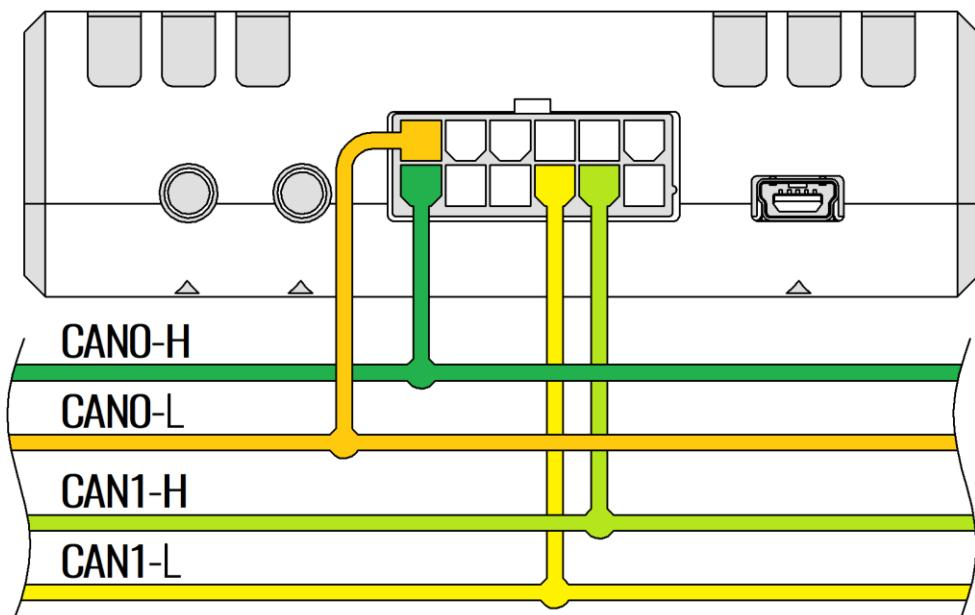
Рисунок 2.24 Подключение к шине CAN
