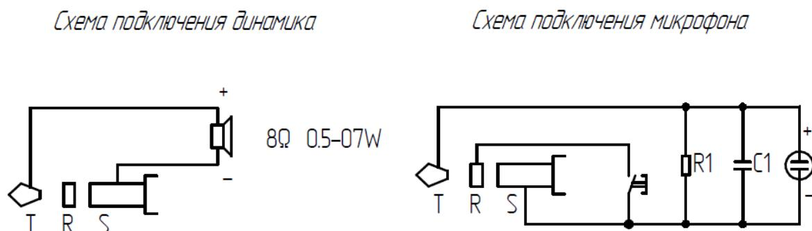
Рисунок 2.29 Схема распайки тангенты
