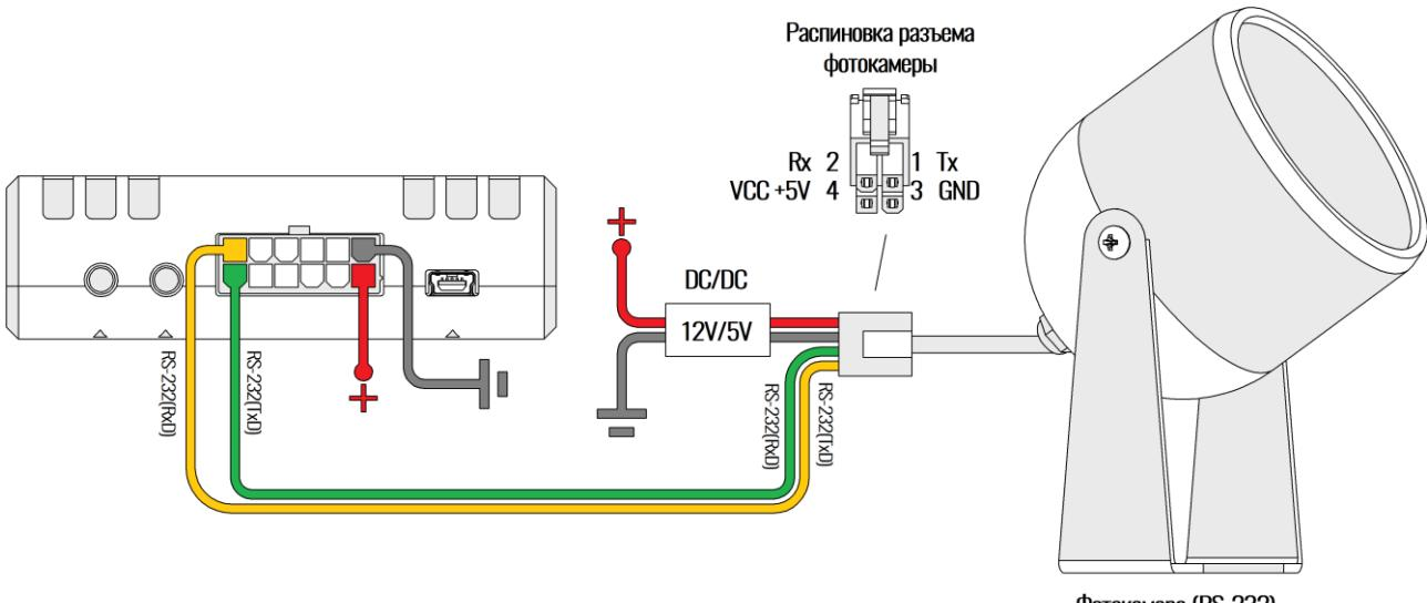
Рисунок 2.30 Подключение фотокамеры JC029F-Y01 с RS-232
