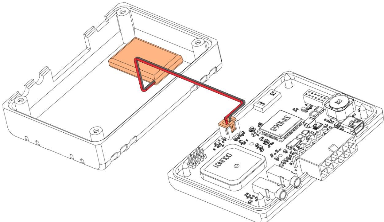
Рисунок 2.9 Установка аккумулятора
